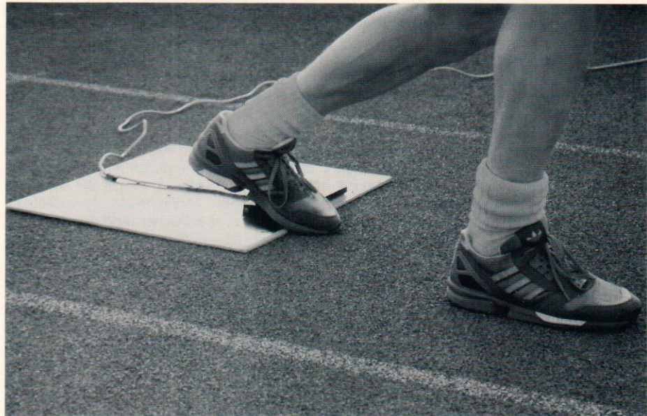
Elektronisch gesteuerte Startplatte beim Sprinttest.
