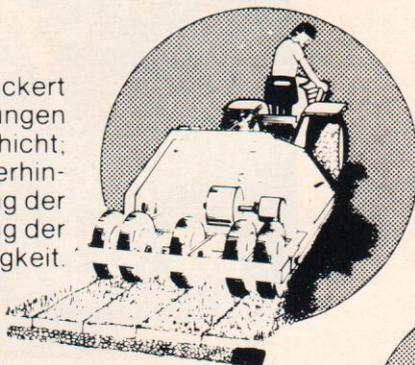
Der **Rasenperforator** – fördert die Durchlüftung des Wurzelhorizontes und sorgt so für bessere Nährstoffausnutzung. Das Perforationsloch wird zum idealen Keimbett für junge Gräser.
